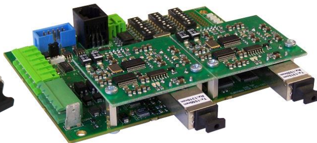
Moduly instalované na síťové desce ústředny
