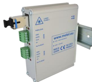
Montaż pionowy na DIN35
